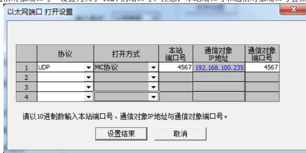
设置结束后，将 PLC 参数下载到 PLC 中，断电重启 PLC 即可生效。
