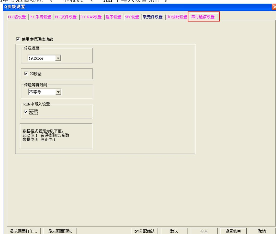
点击设置结束，并将参数下载到 PLC，断电重启 PLC 即可生效。
