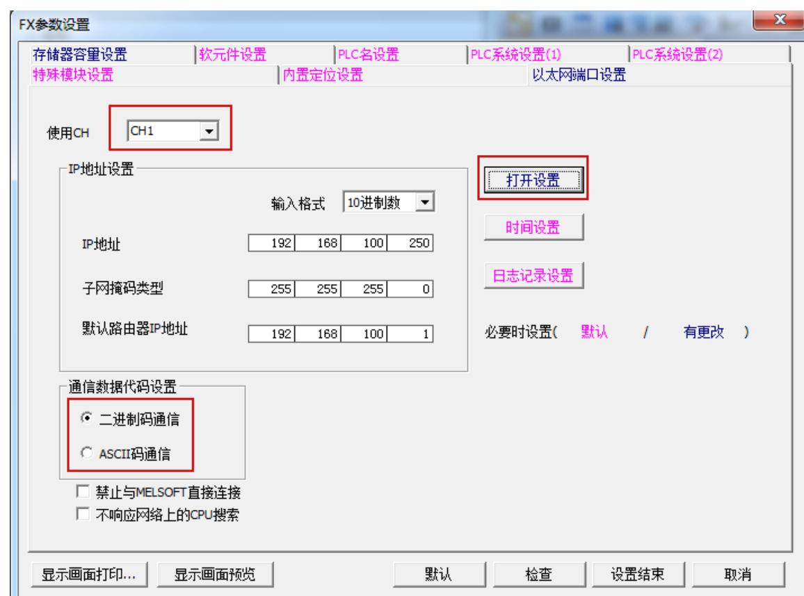
在弹出的对话框中，添加一条新的连接信息：“协议”选择 UDP，“打开方式”选择 MC 协议，“本站端口号”设置一个大于 1024 的未占用端口号，“通信对象 IP 地址”设置为采集端的 IP 地址，“通信对象端口号”设置为大于 1024 的端口号。注意：本地端口号和通信对象端口号会在配置采集端时用到。
