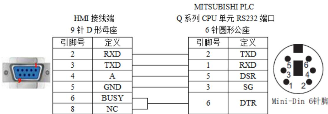
2、Q 系列 PLC 使用 QJ71C24 模块的 RS232 时，电缆制作图如下所示：
